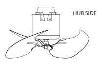
LOCATE FAN BLADE .25" FROM END OF MOTOR SHAFT
