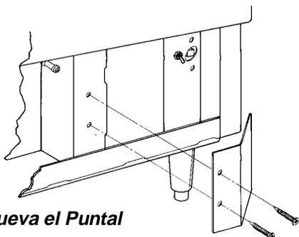
2. Remueva los dos tornillos y el puntal que sujeta el filtro al condensador.
