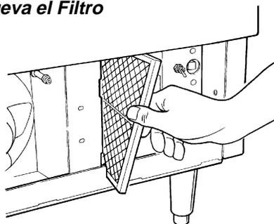
3. Tire el filtro hacia adelante y gírelo un poco para tirar a través de la ranura en la base delantera de la máquina para hacer hielo.
