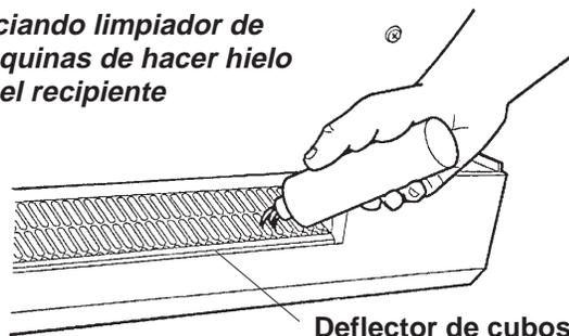
7. Después que la solución de limpieza ha circulado por 10 minutos, presione y suelte el botón de Limpieza. Esto empieza el proceso de enjuague. La luz indicadora de Limpieza estará ENCENDIDA. Nota: El proceso de enjuagado desaloja cualquier residuo del limpiador fuera del sistema de agua de la máquina de hacer hielo.
