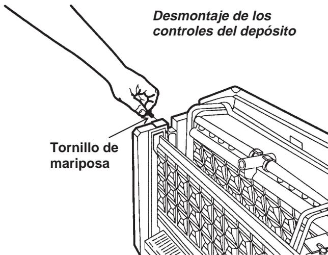
6. Levante los puntales de los controles del depósito hacia arriba y afuera de entre los evaporadores.
