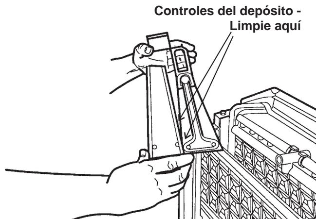
7. Examine la parte inferior de los puntales, hay dos sensores en cada puntal. Revise para verificar que no tengan acumulaciones de minerales. Se pueden limpiar con el Limpiador de máquinas de hacer hielo Scotsman para ayudar a eliminar los minerales. Utilice un cepillo de dientes para quitar la acumulación, si es necesario.
