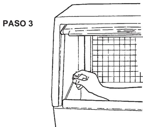
4. Jale el conjunto de cubierta y puerta hacia afuera hasta que se pueda levantar.
