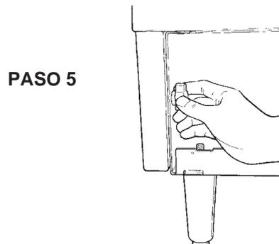
6. Localice el drenaje del depósito. Afloje la abrazadera que sostiene el tubo de drenaje a su conexión, sepárelo de la conexión.
