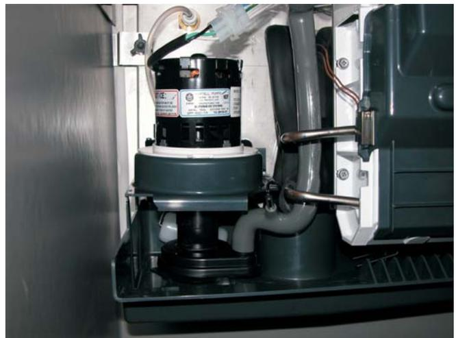
3. Retirer le tuyau de refoulement de la pompe.
