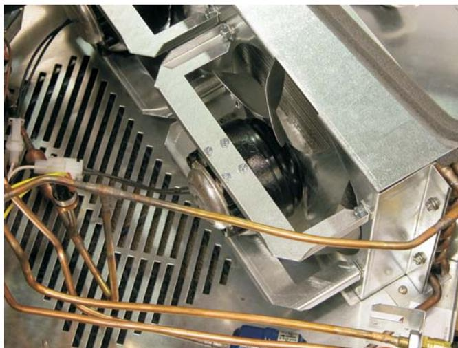
Remplacement de lame ou de moteur de ventilateur
