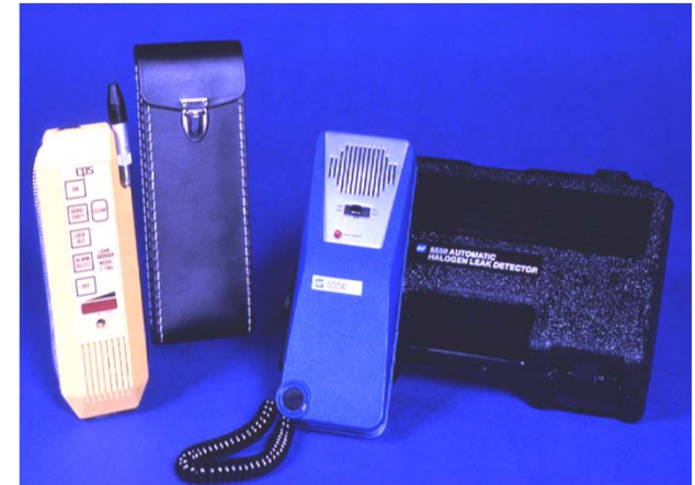
Utiliser des détecteurs de fuite HFC
