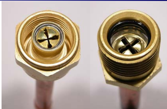
Assemblage incomplet : Un filetage apparent
