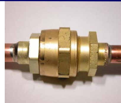
Assemblage incomplet : Un filetage apparent
