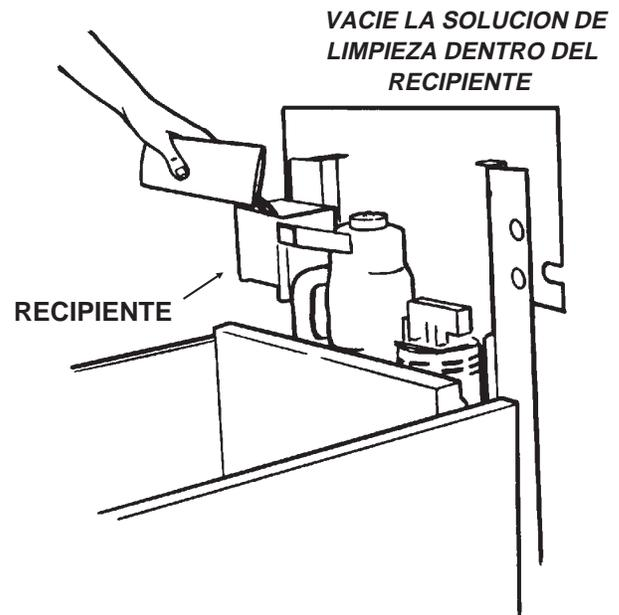
16. Mueva el interruptor principal a ENCENDIDO (ON), continúe vaciando solución de limpieza dentro del recipiente hasta que se haya terminado.
