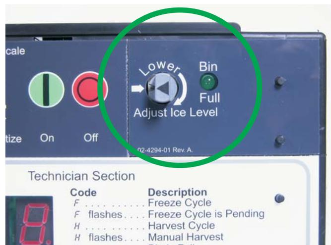
Control ultrasónico mostrado en su posición instalada, configuración a llenado máximo.
