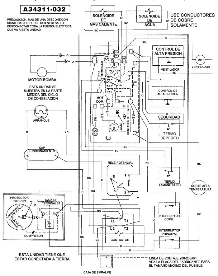
Diagrama Esquemático para la CM650E-32E (208-230/60/1) Enfriada con Aire o Agua.
