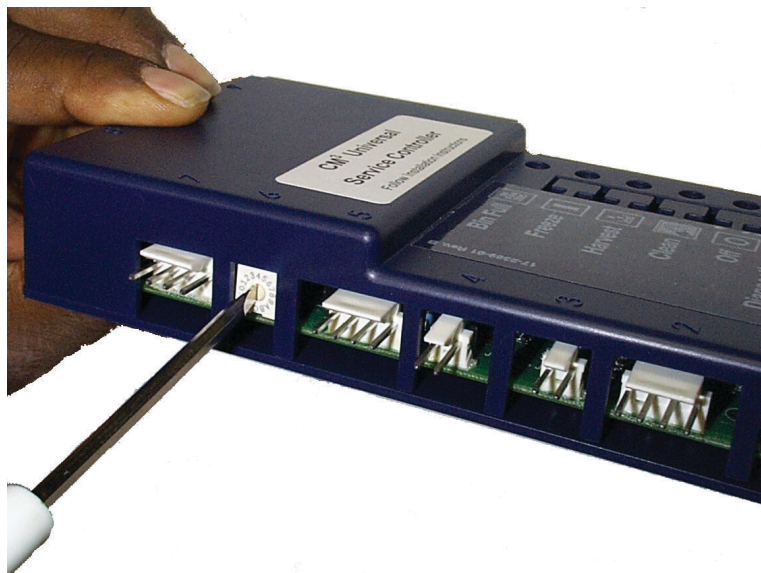
Interruptor selector del controlador de servicio
