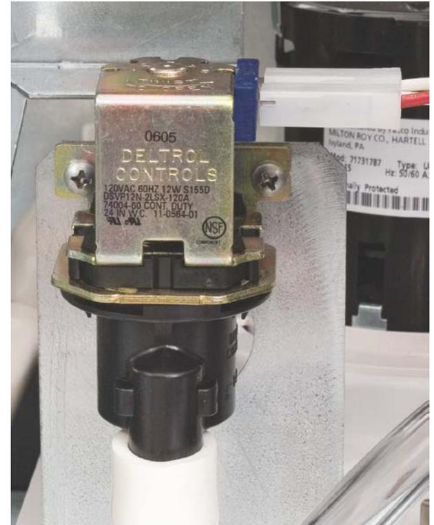
Nota: La válvula de purgado no puede verificarse con un ohmiómetro. En su lugar, verifique el voltaje
